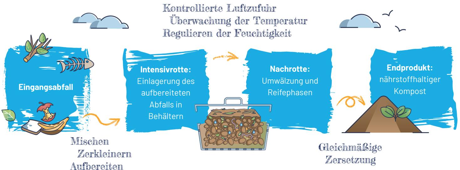
Bei der Kompostierung werden Bioabfälle unter Anwesenheit von Sauerstoff (aerob) mithilfe von Mikroorganismen abgebaut. Der Kompostierungsprozess (auch Rotte genannt) verläuft in der Kompostierungsanlage in zwei Phasen, die auch als **Intensivrotte** und als **Nachrotte** bezeichnet werden.
